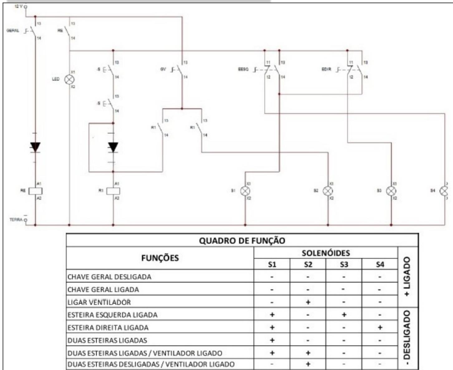
**5.6 - SISTEMA ELÉTRICO - FUSÍVEL (10 AMPERES) - 12 VOLTS**
