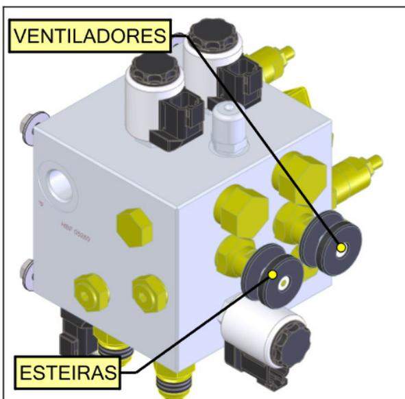
O acoplamento hidráulico ao equipamento auto propelido deverá ser feito conforme indicado neste tópico. A entrada do bloco (P) pressão deverá ser ligada a tomada de pressão do auto propelido.
