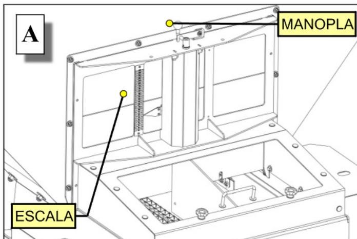
(A) Abertura : A regulagem da abertura da comporta de saída é feita manualmente através de manopla giratória, na parte superior da janela. Esta abertura ou fechamento resulta em uma maior ou menor dose a ser aplicada, pois trata da alteração da área útil de saída. A referência para este quesito é uma régua numerada e com escala em mm, (milímetros) fixada no equipamento.
