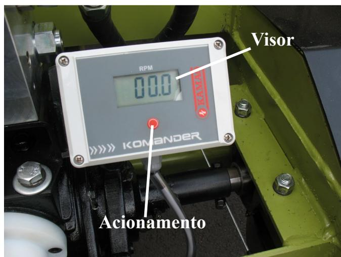
A caixa tem grau de proteção IP 67 sendo totalmente resistente a água e poeira entre outros. Aconselha-se no entanto, evitar o jato direto em caso de lavagem com bicos de alta pressão.
