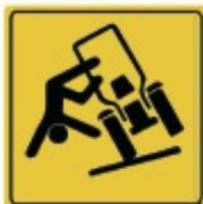
Ao trabalhar em terrenos inclinados, proceda com cuidado procurando sempre manter a estabilidade necessária; em caso de começo de desequilíbrio reduza a aceleração e vire as rodas para o lado da descida;
