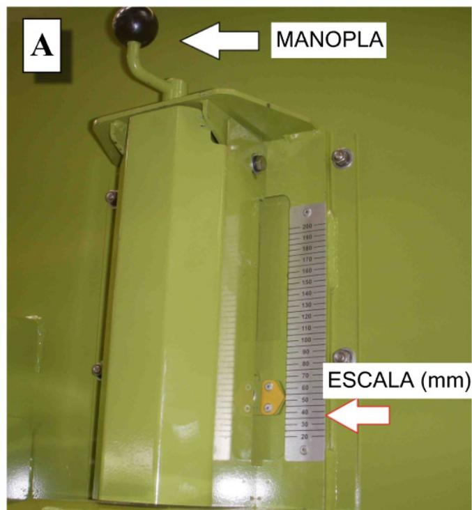
(A) Abertura : A regulagem da abertura da comporta de saída é feita manualmente através de manopla giratória, na parte superior da janela. Esta abertura ou fechamento resulta em uma maior ou menor dose a ser aplicada, pois trata da alteração da área útil de saída. A referência para este quesito é uma régua numerada e com escala em mm, (milímetros) fixada no equipamento.
