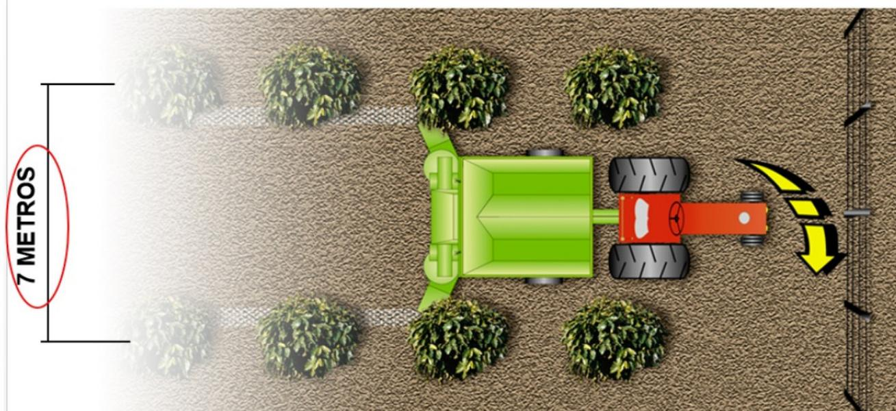
$$\frac{\text{Faixa (m)} \times \text{Velocidade (Km/h)}}{10 \text{ (Constante para Hectare)}} = \frac{7 \times 6}{10} = \frac{42}{10} = 4,2 \times \text{rendimento (0,90)} = \mathbf{3,78 \text{ Ha/Hora}}$$
