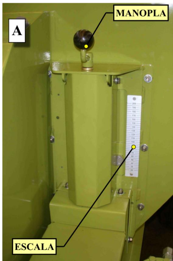
(A) Abertura : A regulagem da abertura da comporta de saída é feita manualmente através de manopla giratória, na parte superior da janela. Esta abertura ou fechamento resulta em uma maior ou menor dose a ser aplicada, pois trata da alteração da área útil de saída. A referência para este quesito é uma régua numerada e com escala em mm, (milímetros) fixada no equipamento.
