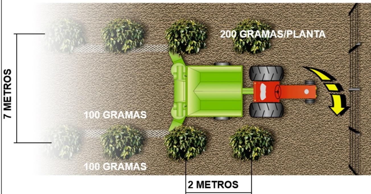
$$\frac{200 \text{ GRAMAS/PLANTA}}{2 \text{ LADOS DE APLICAÇÃO}} = \frac{100 \text{ GRAMAS/LADO}}{2 \text{ METROS}} = 50 \text{ GR/METRO LINEAR}$$
