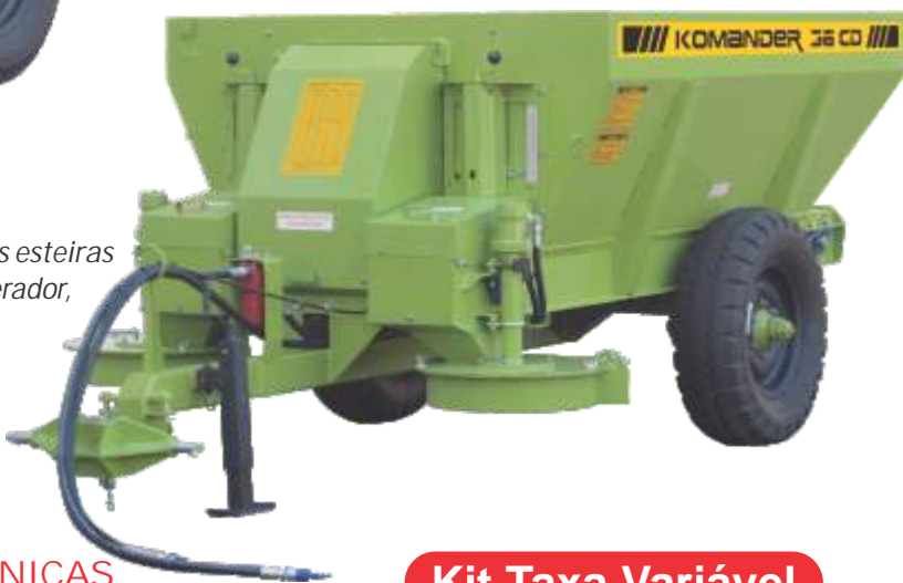
Comando elétrico das esteiras (Não utiliza nenhum cabo de aço)
